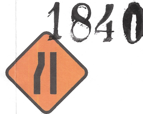
T. 4 (B) ESTRECHAMIENTO DE CALZADA (IZQUIERDA)
